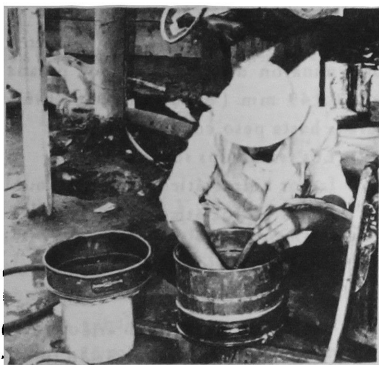
Fig. 7. Lavado de la muestra sobre tamices N° 4 y N° 100 ASTM.
